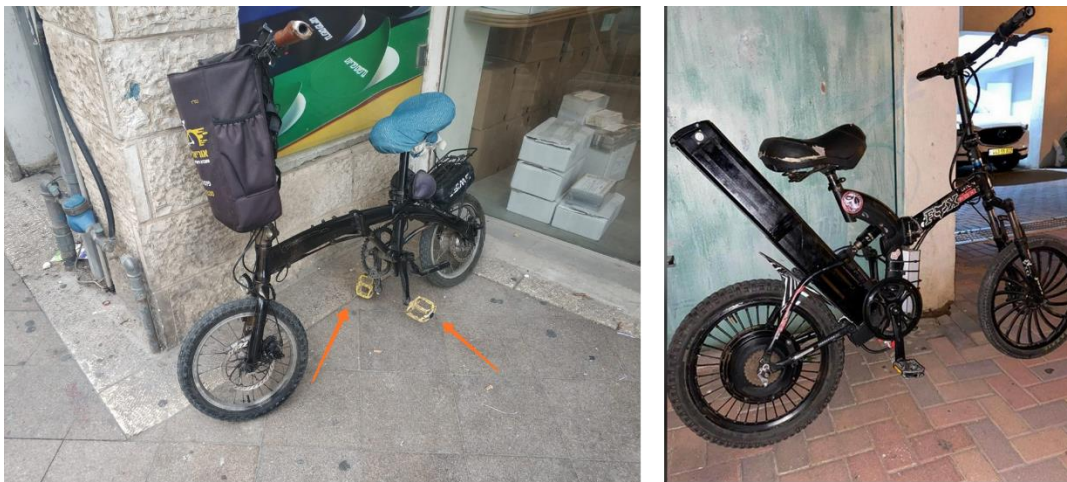
תמונה 3 - ימין - אופניים חשמליים לא תקינים, עם סוללה מחזוקת. שמאל - אופניים חשמליים לא תקינים. מיקום הפדלים הוחלף על מנת לאפשר לרוכב להניח את שתי רגליו בנוחות, מאחר שאין כוונה שיעשה בהם שימוש לפדל.
