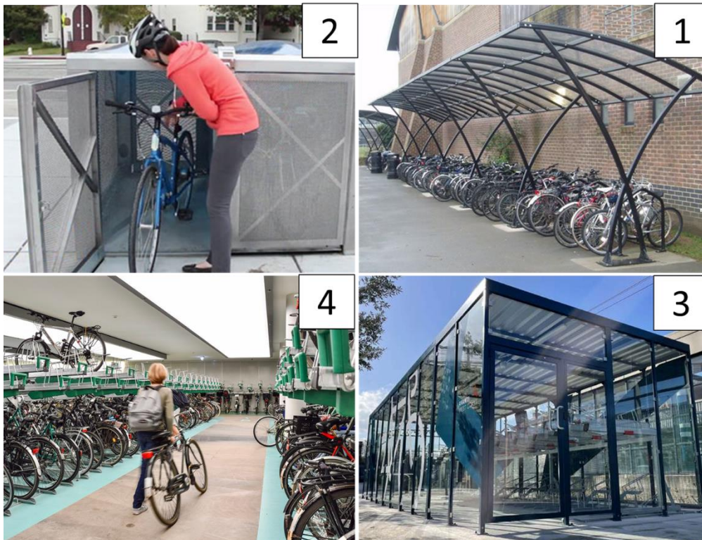
תמונה 3- סוגי מתקני החנייה השונים. 1- סככת אופניים פתוחה. 2- לוקר אופניים. 3- חדר אופניים סגור, גישה נשלטת 4- חניון/תחנת אופניים בתוך מבנה
