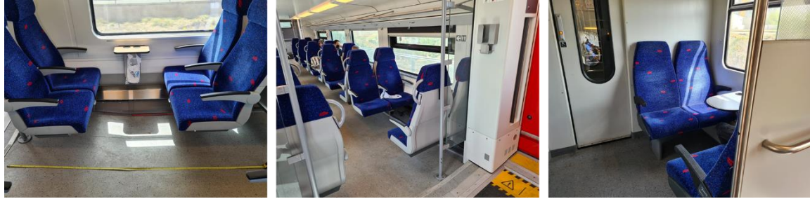
תמונה 7 – ימין: איזור אפשרי להנגשה לאופניים בקרונות מסוג בומברדייה. מרכז: איזור אפשרי להנגשה לאופניים בקרונות מסוג סימנס דזירו. שמאל: מדידת מרחק "גב אל גב" של מושבים בקרונות סימנס (180 ס"מ)
